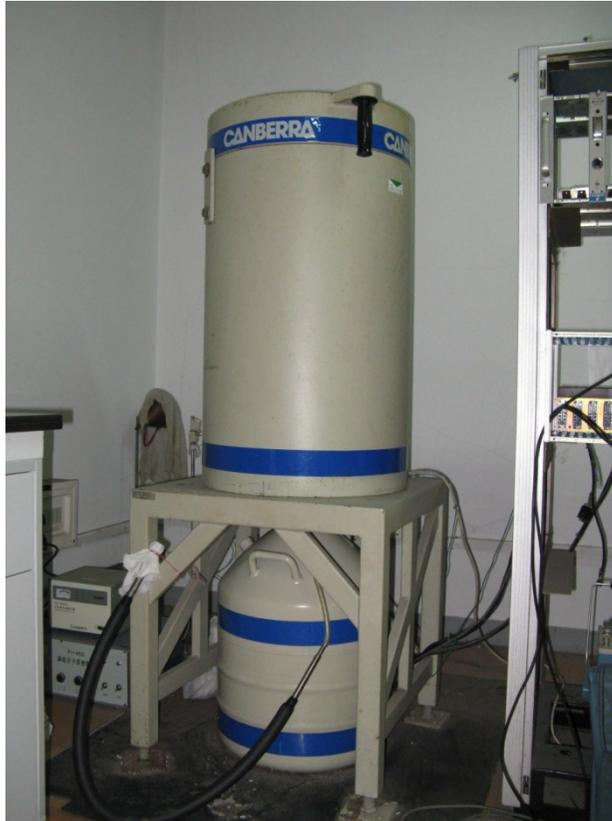
CANBERRA 低本底Gamma测量装置，本底水平在1cps。
