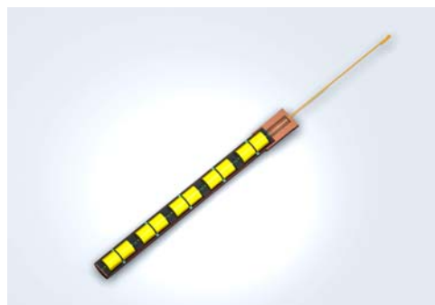
由10个探测器组成一个模块。内部真空，外壳为高纯材料
